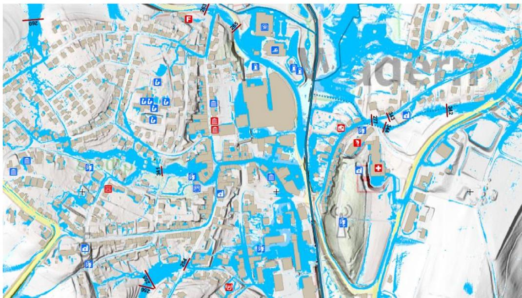
Abb. 14: Beispiel einer Kartendarstellung mit Überflutungsausdehnung bei drei Starkregensszenarien und Kennzeichnung von besonderen Risikoobjekten (Geomer, Wadern, 2018)
