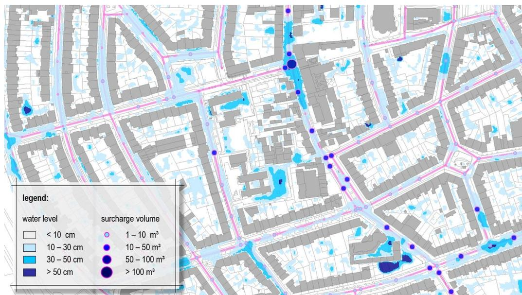
Abb. 13: Beispiel einer Überflutungskarte auf Basis einer 1D/2D-Abflusssimulation
