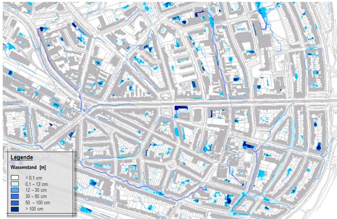
Abb. 11: Ergebnisbeispiel einer topografischen Analyse mit statischer Volumenbetrachtung (Fließwege, Wassertiefen in Geländesenken)
