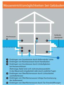
Abb. 3: Wassereintrittsmöglichkeiten bei Gebäuden (BMVBS, 2010)
